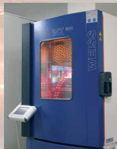
Klimaprüfung der Platinen im Werk
